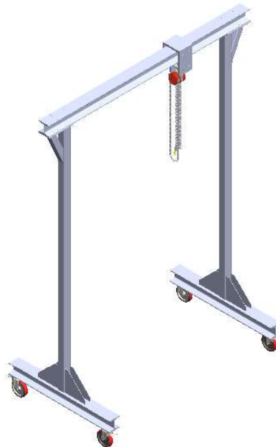
Gambar 4. Struktur Hoist Gantry Crane (HGC)
