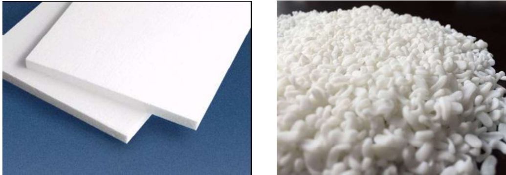
Gambar.7 Material HIPS (kiri) dan raw material ABS (kanan)
