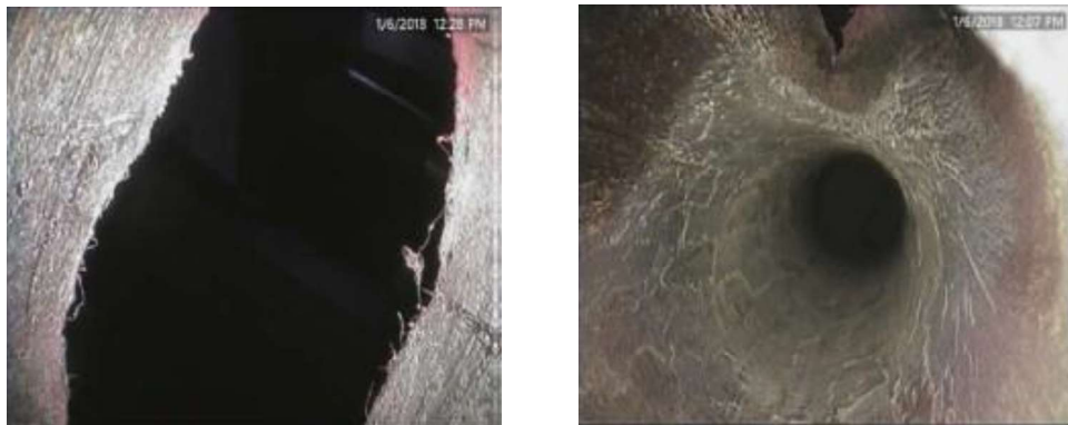
Gambar 3.5 Hasil pemeriksaan pipa dengan boroscope
