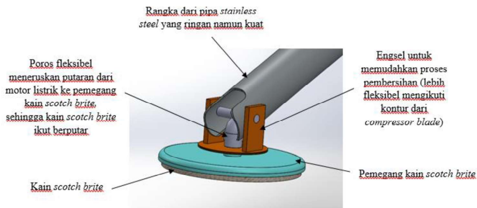
Gambar 4 – Cara Kerja Rancangan Alat Bantu Pembersih Compressor Blade
