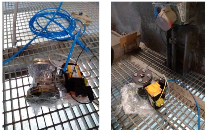
Gambar. 4 Pengujian control valve sebelum dipasang
