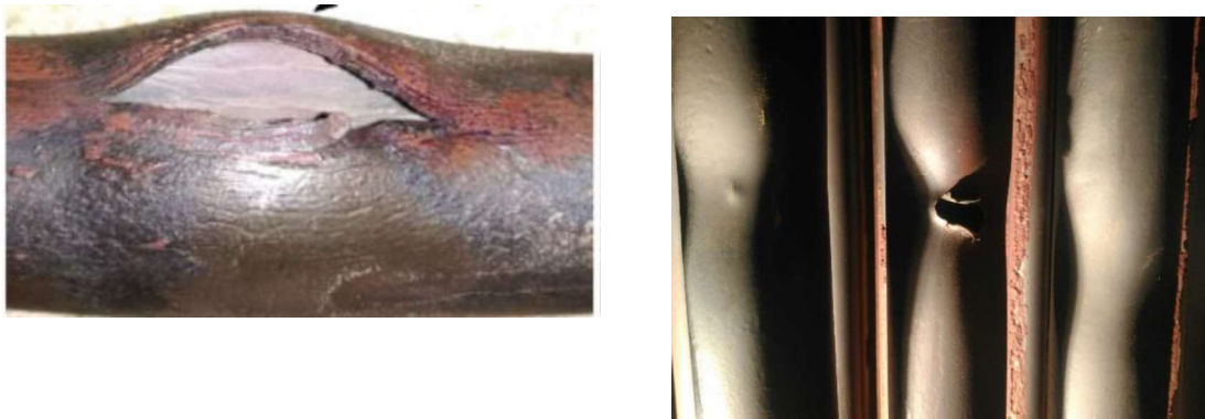
Gambar 3.4 Bentuk Pecahan Pipa SSH
