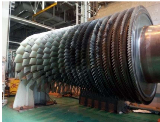
Gambar 2 - Compressor blade pada rotor turbin gas Mitsubishi M701F
