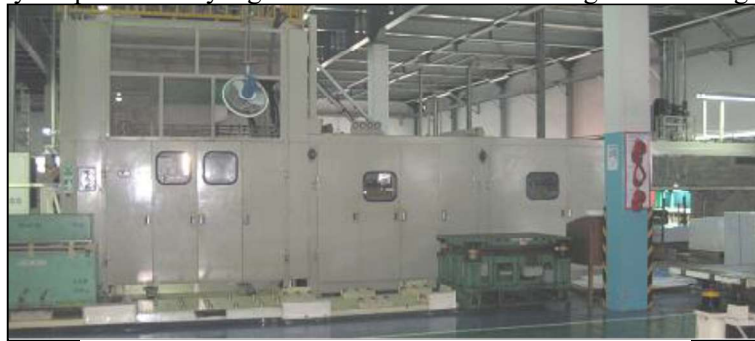
Gambar.10 Penambahan kipas angin untuk bagian forming
