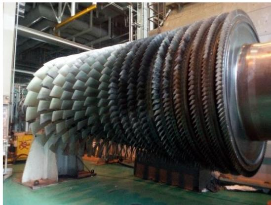
Gambar 2 - *Compressor blade* pada rotor turbin gas Mitsubishi M701F
