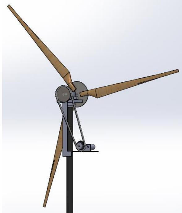
Gambar. 1 *Design Turbin Angin menggunakan transmisi*
