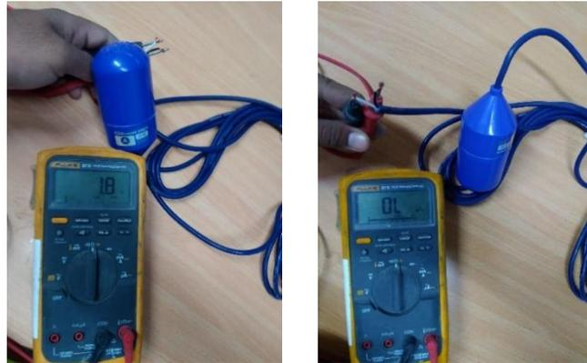
Gambar. 3 Pengujian level sensor sebelum dipasang
