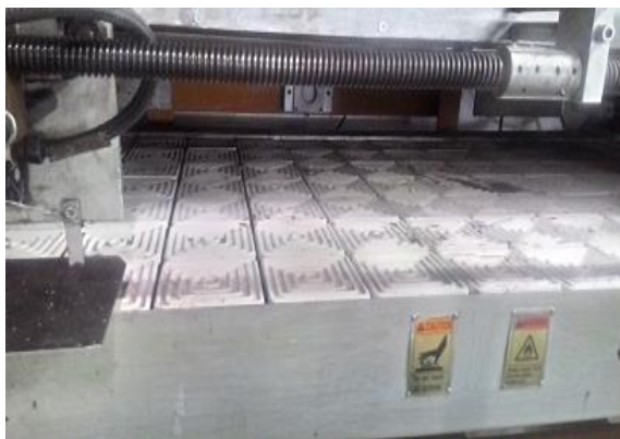
Gambar.11 Penambahan sensor dan pengaturan digital suhu untuk bagian heater
