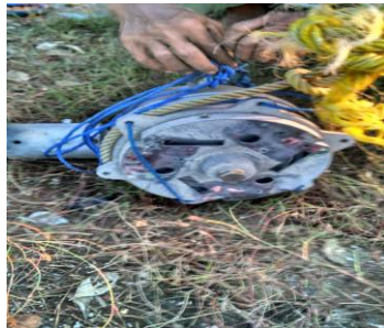
Gambar 3. Turbin yang berkarat
