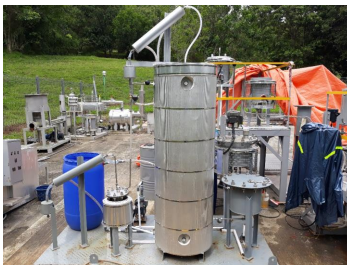
Gambar 4. Hasil Alat Mini Plant Fuel Grade Ethanol Kulit Singkong
