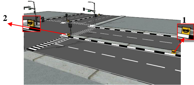
Gambar 6. Tata letak sensor pada smart traffic light system
